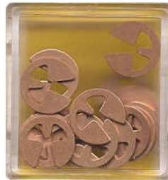
E-spring ESB brons – 25 stuks fosfor-bronzen wisselrad-opsluit- schijfjes voor oudere reguleurs en schoorsteenklokken (1,4x8,4x0,4 mm)
